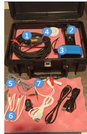
Configuration de base : Hydrophone + Enregistreur + HP
